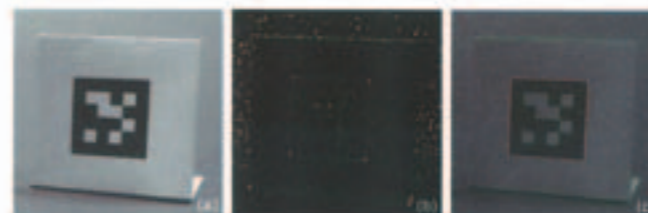
Figuur 2: Het proces van markerherkenning bestaat uit een aantal stappen. In eerste instantie worden in het originele plaatje (a) de randen en hoekpunten gezocht (b). Het combineren van deze structuren vormt de basis voor de herkenning (c).
